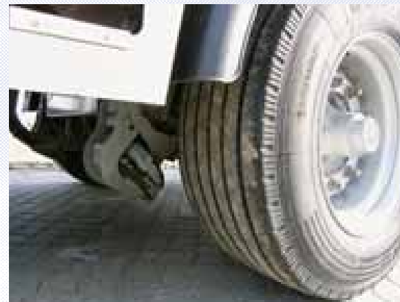
Bogielift på de to forreste aksler i trippelbogi.
